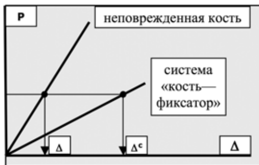
Рис. 3. Типичные диаграммы деформирования при кратковременном нагружении неповрежденной кости и системы «К–Ф»
