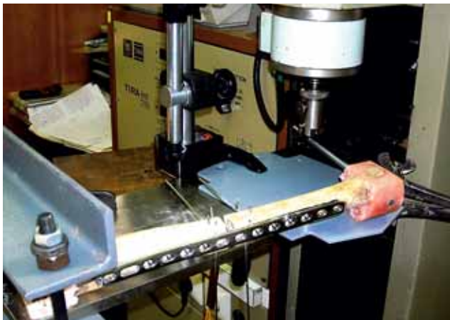
Рис. 1. Большеберцовая кость с фиксирующей пластиной во время измерений на рабочем столе испытательной машины
