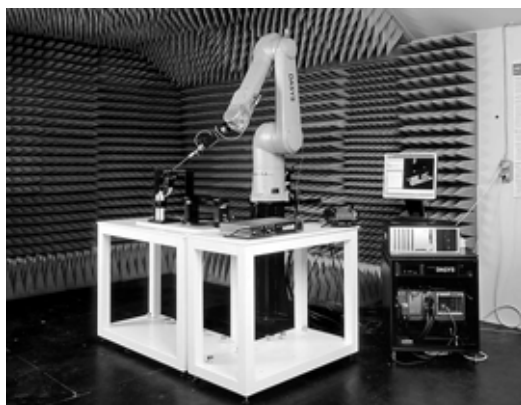
Рис. 3. Установка для дозиметричного вимірювання неіонізованого випромінювання
