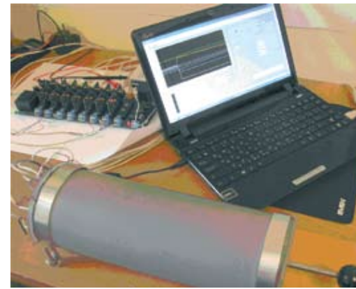
Рис. 8. Програмно-апаратний комплекс «Електронний ніс»
